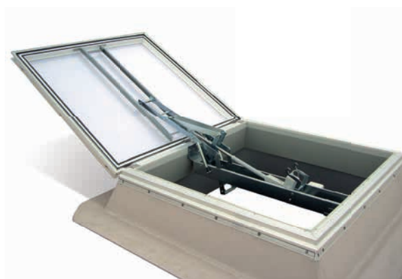
Cupolă luminoasă JET TOP-90 PLUS cu dispozitiv pentru evacuarea a fumului și a căldurii 24V/48V/230V montată pe sistemul de soclu JET
