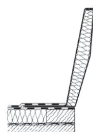
Sistem soclu din compozit oțel-aluminiu pentru instalații de evacuare a fumului și a căldurii tip RAK; înălțimea de 30 cm
