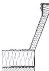
Sistem soclu metalic tip TE, cu înălțimea de 40 cm, cu șină de prindere E
